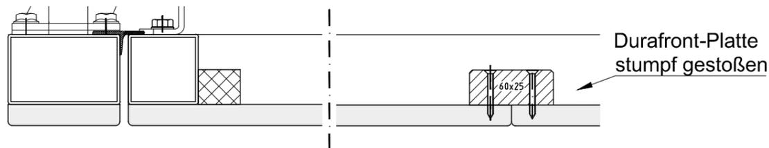
die maximale Plattenabmessung beträgt in 1210 x 3000 mm
