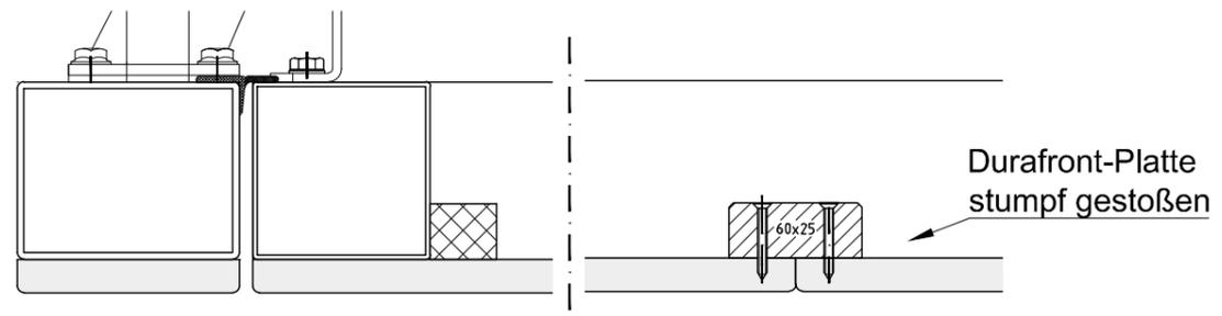
die maximale Plattenabmessung beträgt in 1210 x 3000 mm
