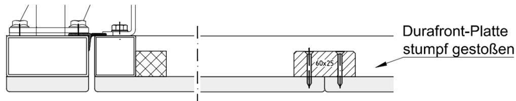
die maximale Plattenabmessung beträgt in 1210 x 3000 mm
